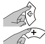
Zur Aktivierung der Funktion die Tasten "Betriebsart" und "+" gleichzeitig drücken und beide gedrückt halten, bis das Symbol
