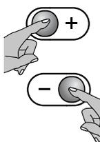
Zur Aktivierung der Funktion die Tasten "+" und "-" gleichzeitig drücken und beide gedrückt halten, bis das Symbol
