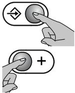
Zur Aktivierung der Funktion die Tasten "Betriebsart" und "+" gleichzeitig drücken und beide gedrückt halten, bis das Symbol
