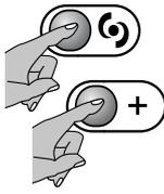
Um die Hinterleuchtung zu deaktivieren, die Tasten "LED OFF" und "+" gleichzeitig drücken und beide gedrückt halten, bis auf dem Display der Fernbedienung der Text "LED OFF" erscheint.
